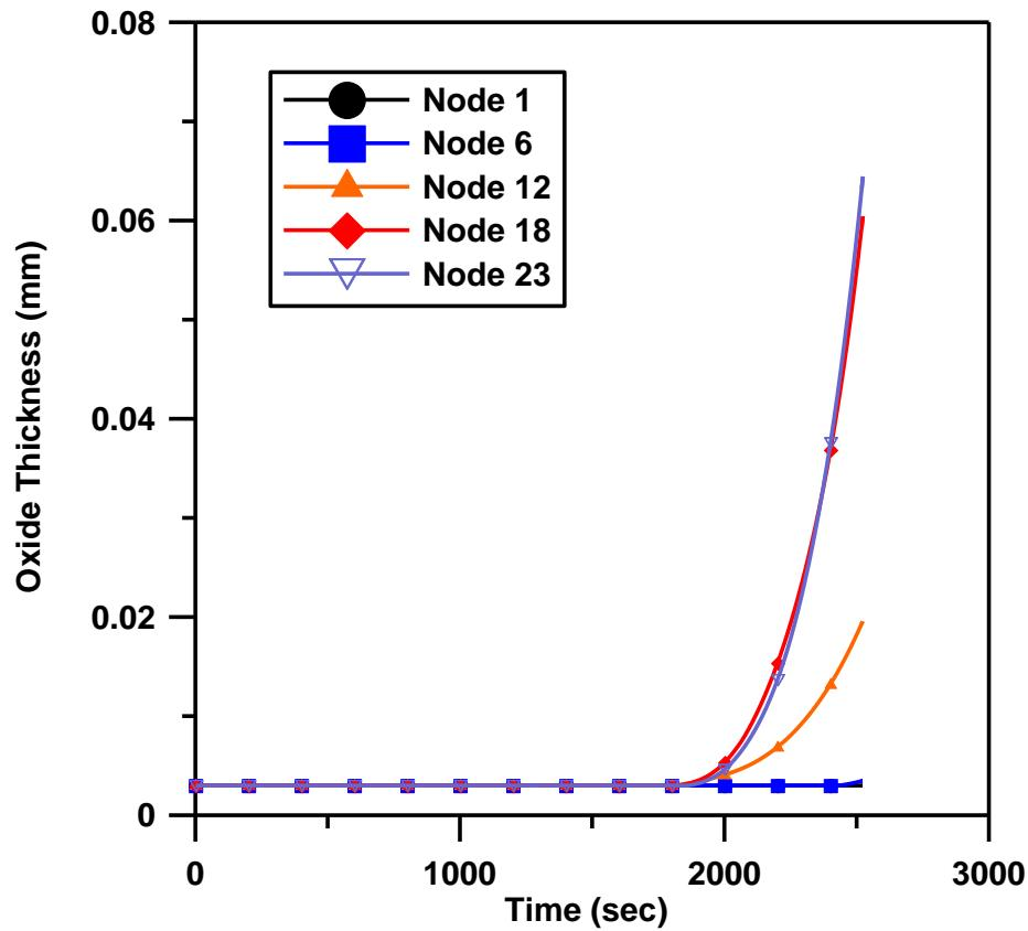
發生鎔水反應，護套於node 18破損
