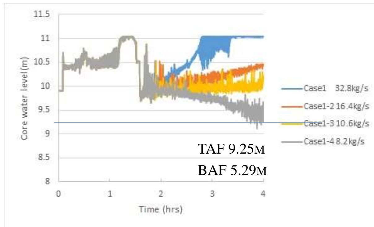
若依據TRACE的結果，生水量8.2kg/s將不足以冷卻衰變熱，造成爐心水位持續下探。
