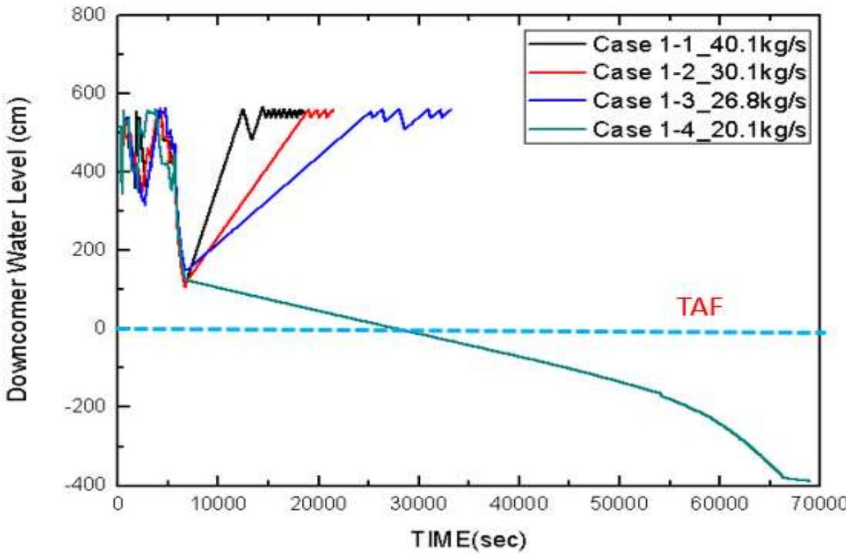
若依據PCTTRAN的結果，生水量20.1 kg/s將不足以冷卻衰變熱，造成爐心水位持續下探。建議生水的最小注入量應為26.8 kg/sec以上
