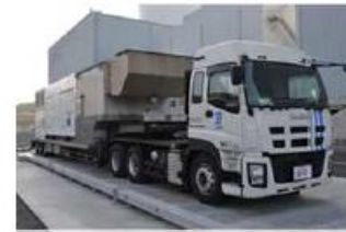
大容量氣冷式發電機
